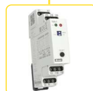
TER-7 Kontrola zagrzewania uzwojeń silnika w zakresie oporowym wbudowanego PTC termistora (1.8-3.3 kΩ), funkcje (pamięć, reset), styk wyjściowy 2x 8A CO, zasilanie: 24-240 V AC/DC. str. 135
